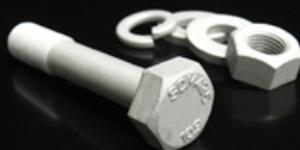
DISGO は表面処理方で、現在最先端の塗装技術です。皮膜構造はベースコートとトップコートの2層で構成されており、高力ボルトにディスコ処理をすることにより、水素脆性がないので遅れ破損の心配のないボルトとして使えます。クロムフリーでこの高耐食性は他を圧倒しています。
