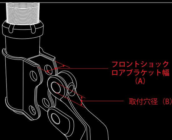
図の (A) (B) の寸法を確認し、取付車両に適したキャンバーボルトを選択してください。
